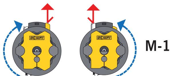
El motor conectado en los polos 5-6 y 7, será el motor maestro. La regulación de los finales de carrera se hace únicamente en este motor.
