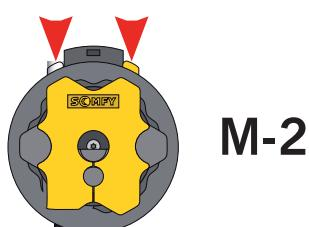
El motor conectado en los polos 8-9 y 10, deberá tener los finales de carrera siempre presionados.
